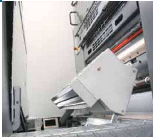
Secador intermedio basculante, en posición superior: puede cambiarse de sitio con rapidez y facilidad e instalarse entre distintos cuerpos impresores. Ocupa siempre la posición adecuada para cada trabajo.
