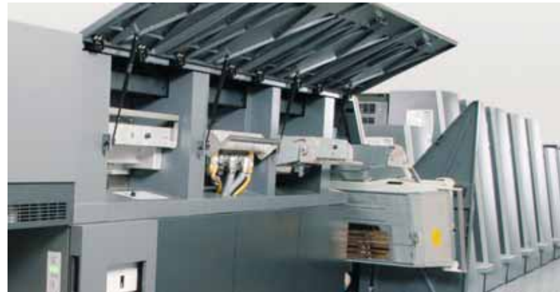
Equipamiento UV en la salida: los módulos de secado funcionan con acreditados elementos intercambiables y disponen de acoplamientos rápidos para el secador final UV.
