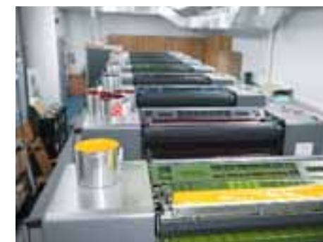
Visión panorámica de los grupos de entintado: la Speedmaster de ocho colores en Concept Press.
