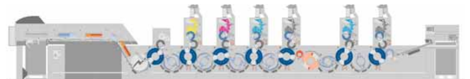
Detalles técnicos: Gracias a su tecnología, la Speedmaster CD 74 marca el rumbo en el formato mediano. Los modelos con dispositivo de inversión están disponibles en versiones de cuatro, cinco y seis colores. Los modelos sin inversión pueden imprimir incluso hasta ocho colores. El dispositivo de inversión conmutable –situado, por ejemplo, entre el segundo y el tercer cuerpo impresor (véase la foto)– mantiene el conocido e impecable nivel de calidad de la Speedmaster en la impresión de cara y retiración y permite procesar incluso soportes gruesos y poco flexibles.
