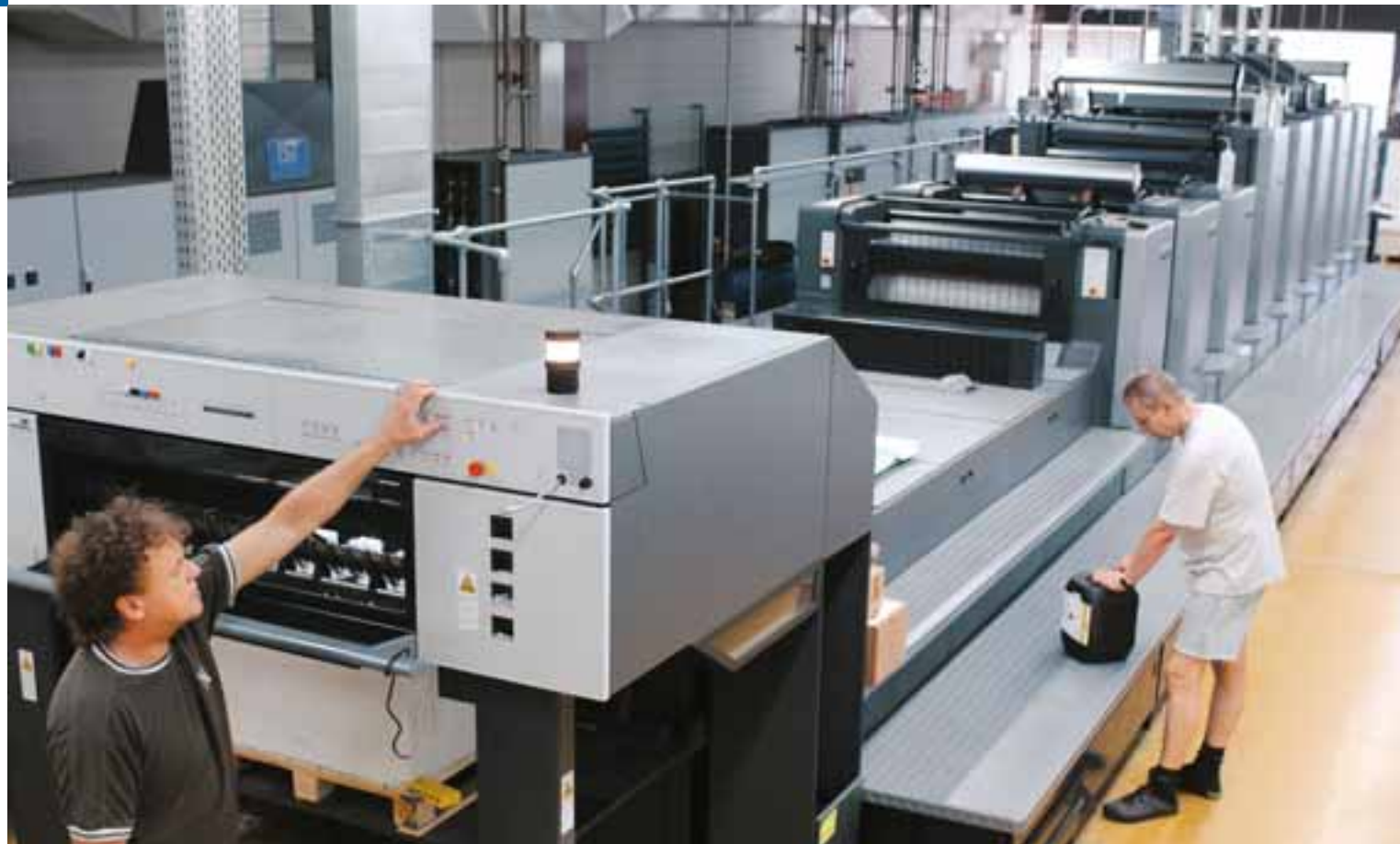
Olaf Herzog (primer plano) y Michael Marquardt trabajan en la Speedmaster CD 102 de Multicolor en Ellerau. La máquina dispone de dos cuerpos barnizadores y una salida prolongada para el barnizado en línea. Los vapores de tinta son eliminados por extractores situados encima de cada grupo entintador.
